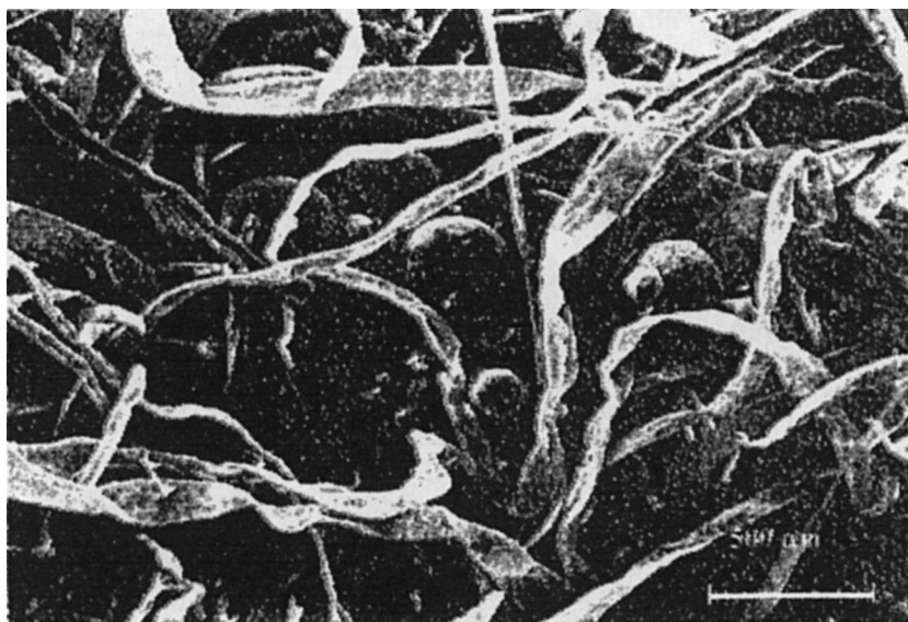
Fig. 1. Vue de la distribution des particules de SAP dans le matelas fibreux.
